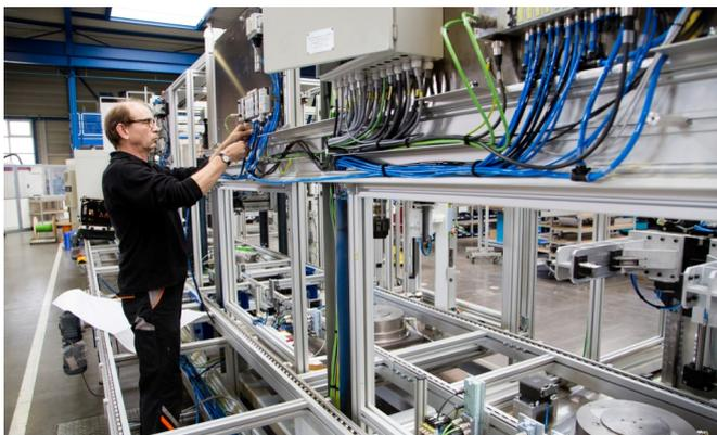
*Installation der komplexen elektronischen Steuerungen*
